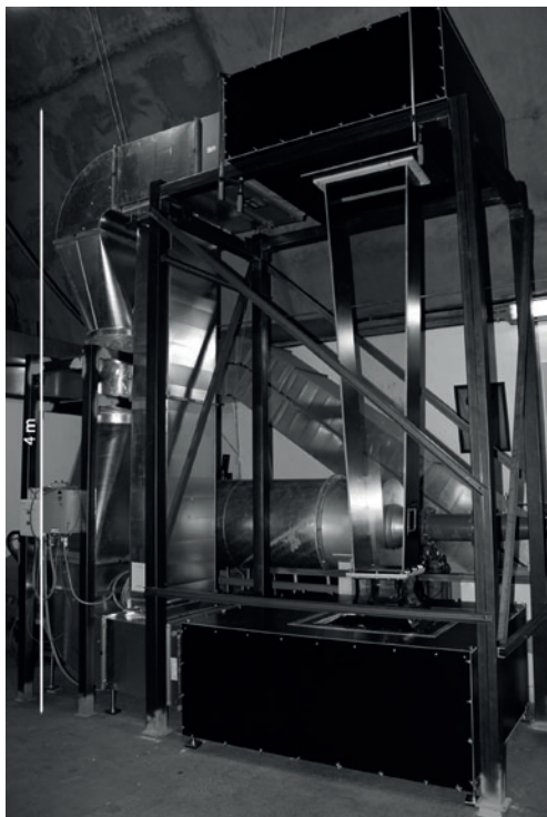
Figure 4.–La soufflerie verticale pour l'étude de la vitesse terminale et de l'agrégation des particules; The wind tunnel for the study of terminal velocity and aggregation of volcanic particles.
