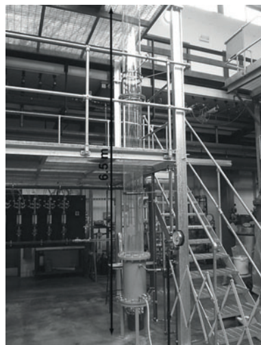
Figure 2.–La colonne verticale pour l'étude de l'écoulement des bulles de gaz dans les magmas basaltiques.
