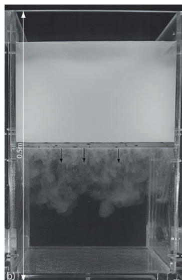
Figure 3.–a) Instabilités convectives (par exemple celles indiquées par les flèches noirs) à la base du panache généré lors de l'éruption du volcan Eyafjallajökull (4 Mai 2010), b) et dans le réservoir en Plexiglas construit en laboratoire pour les étudier.
