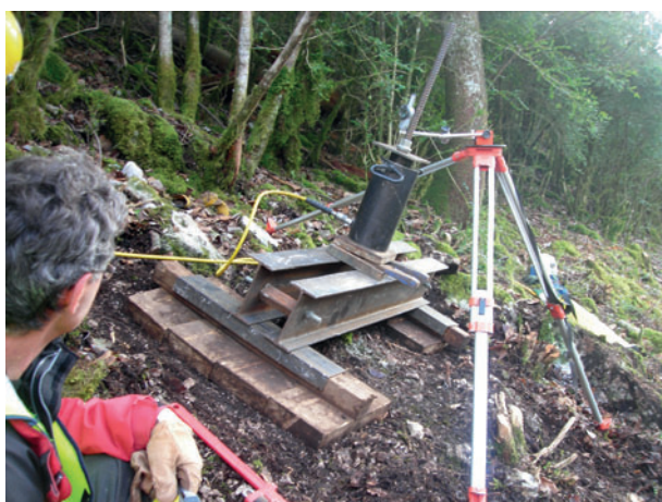
Figure 15.—Test de traction sur ancrage de filet 3000 kJ (Sylans); photo BG / Hugues Foltzer.
