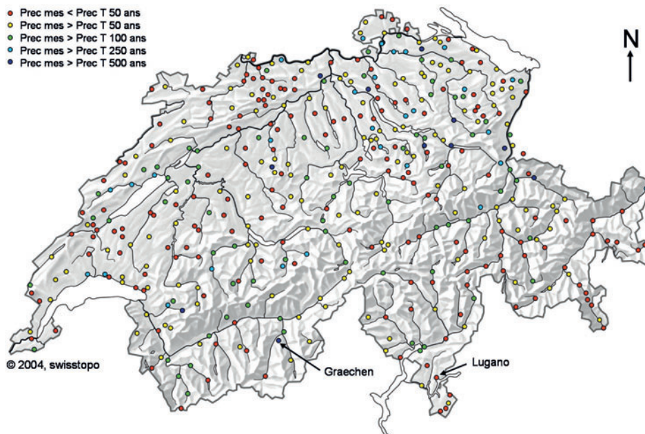
Figure 3.—Comparaison entre les précipitations journalières maximales mesurées sur le terrain de 1961 à 2010 et les précipitations journalières estimées par les analyses de Gumbel pour plusieurs temps de retour.
