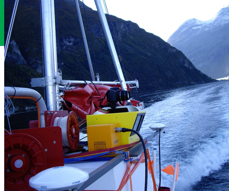
Aquisition Lidar depuis un bateau dans les fjords norvégiens
