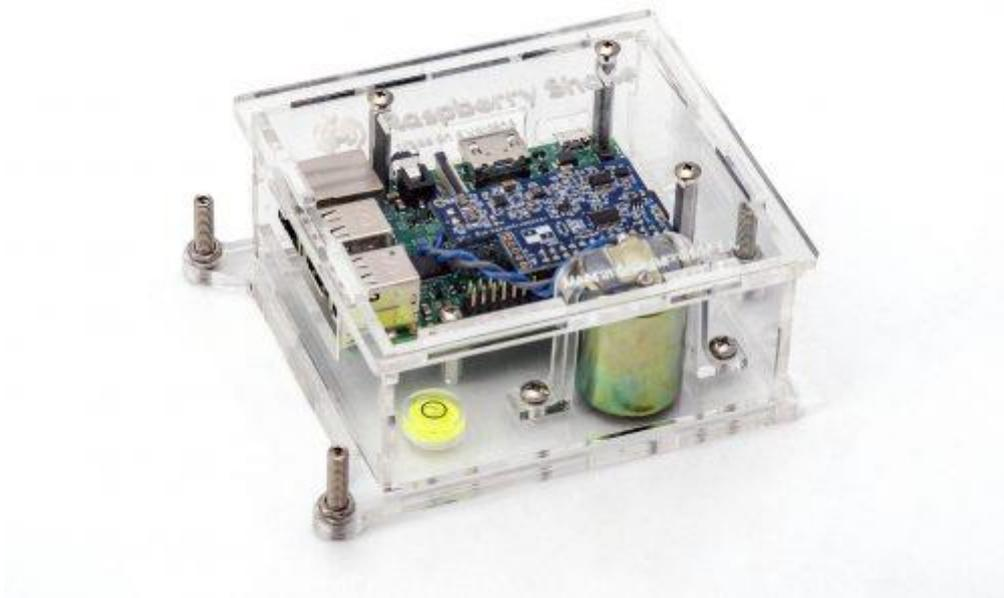
*Le sismomètre RasperryShake-1D (de [www.raspberrysshake.org](http://www.raspberrysshake.org))*
