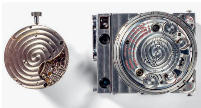
Finitions Côtes de Genève sur un mouvement 204 (1932) et l'appareil Compass (1937) de Jaeger-LeCoultre (MSAP).
