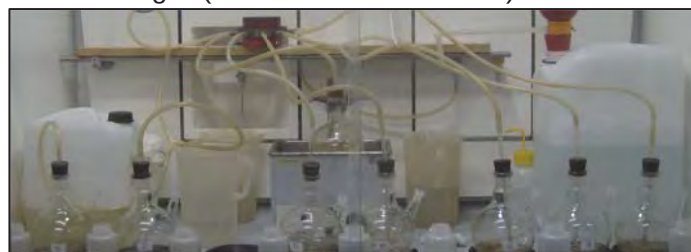
Fig. 44 : décarbonatation par ajout de HCl, d'air soufflé et passage dans un bain à ultrasons
