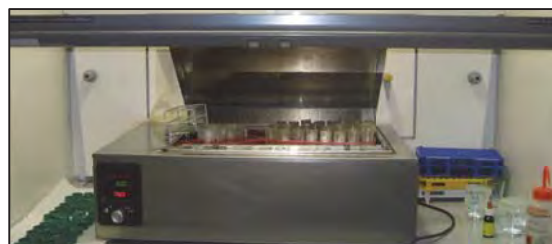
Fig. 40: destruction de la matière organique des échantillons de sol au moyen d'eau oxygénée
