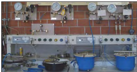
Fig. 51 : presses à membranes pour les hautes pressions à droite et pour les pressions très élevées à gauche
