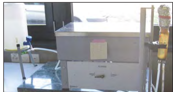
Fig. 50 : bac à succion permettant de gérer la distance de l'eau à l'échantillon
