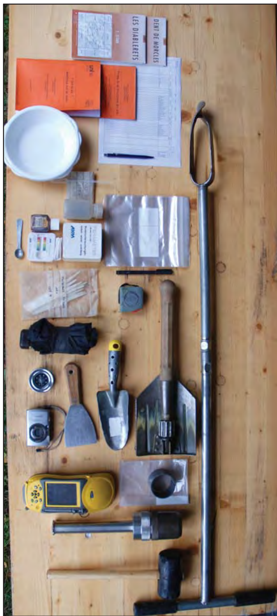
Fig. 36 : Matériel de terrain : de haut en bas : cartes topographiques de la Dent de Morcles et des Diablerets, fiche de relevés (annexe. 1), protocole de description des sols, clé de sol, stylo bille, assiettes, sachets plastiques, stylo indélébile, HCl 10% et pipette, pH Hellige, 10 marqueurs d'horizon, double mètre, pelle, pellette, spatule, parapluie, boussole, appareil photo, GPS, cercles plastiques, sachets plastiques minces, préleveur de carottes, maillet, tarière.
