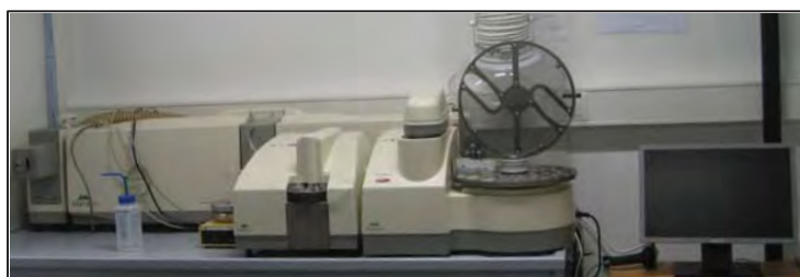
Fig.41 : granulomètre laser (Mastersizer 2000 de Malvern)
