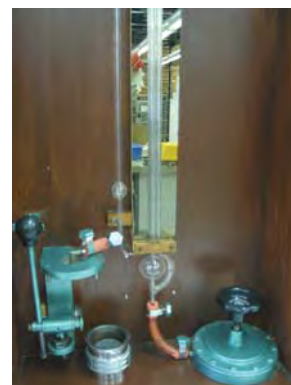
Fig. 53 : pycnomètre à air
