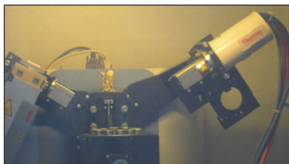
Fig. 43 : analyse par diffraction aux rayons X avec le thermo-xtra de Thermo Fisher Scientific Inc.
