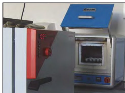
Fig. 47 : à gauche, étuve à 105°C pour enlever l'humidité résiduelle, à droite, four pour la carbonisation à 450°C
