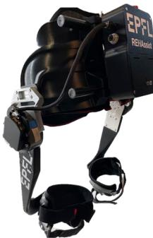
Le groupe REHAssist de l'EPFL a développé eWalk, un exosquelette de hanche conçu pour suivre de manière synergique les mouvements volontaires de l'utilisateur. eWalk est un appareil léger, portable et confortable, dont l'objectif principal est d'améliorer la capacité naturelle de marche et de réduire la fatigue.
