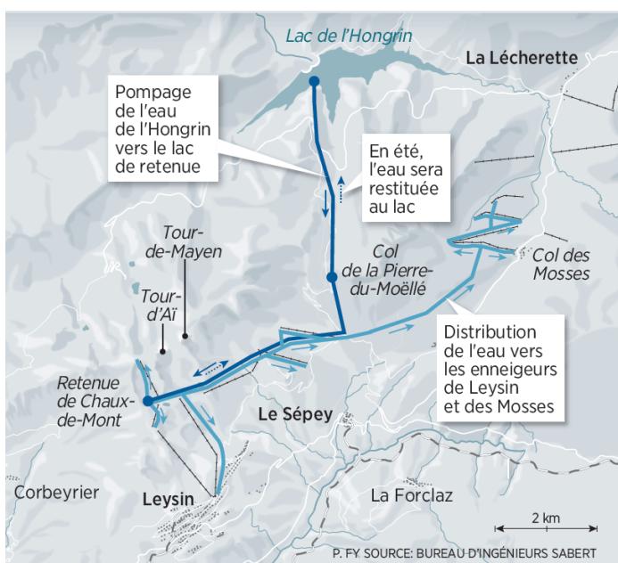
Figure 24. Carte représentant le projet d'enneigement artificiel depuis le réservoir de l'Hongrin. Source : Bureau d'ingénieurs Sabert
