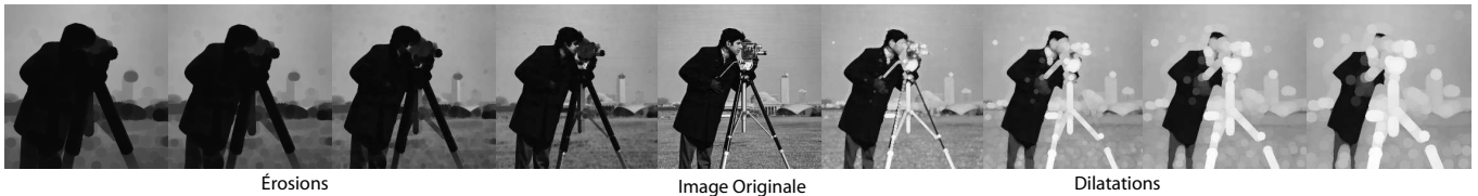
Figure 1.3: Érosions (vers gauche) et dilations (vers droite) de l'image originale (centre) en utilisant un élément structurant B circulaire de rayon [2, 4, 6, 8] pixels. (Image example de MATLAB, 'cameraman.tif')
