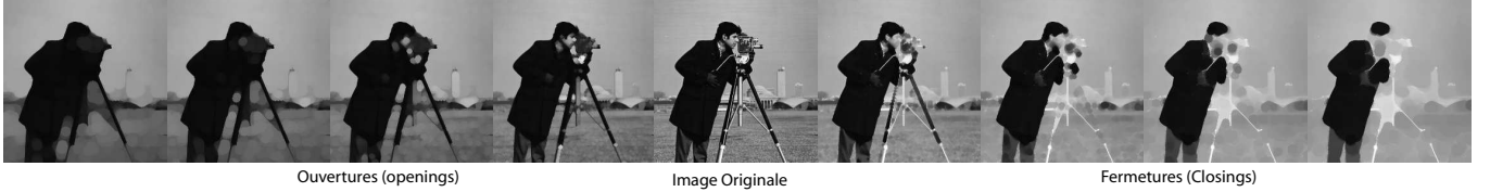
Figure 1.4: Ouvertures (vers gauche) et fermetures (vers droite) de l'image originale (centre) en utilisant un élément structurant B circulaire de rayon [2, 4, 6, 8] pixels.
